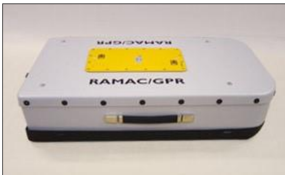
Figura 5. Antena blindada de 250MHz do sistema Ramac/GPR.
